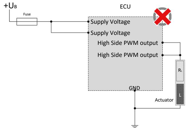
Die kombiniert nutzbaren Pins (I/Os) dürfen extern nicht gegen eine höhere Spannung als die Versorgungsspannung geschaltet werden.
