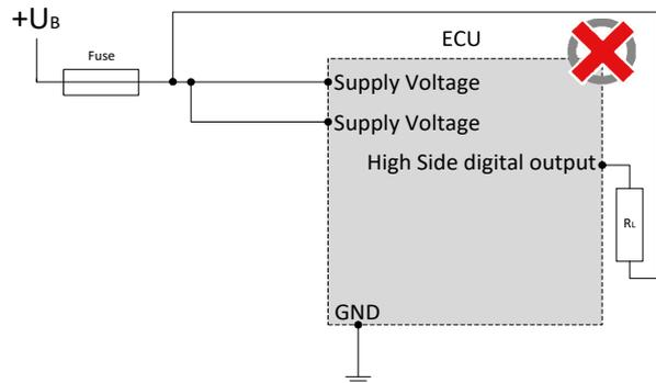
Die Sensorversorgungen können durch die externe Beschaltung z.B. das Anlegen einer höheren Spannung „hochgezogen“ werden, da Sie nur als Spannungsquelle nicht aber als Spannungssenke arbeiten. Das Hochziehen einer Spannungsquelle kann zu unvorhersehbaren Fehlfunktionen und bei dauerhaftem Betrieb zur Beschädigung des Steuergeräts führen.
