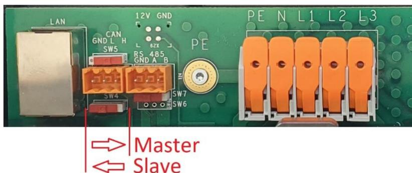
Befindet sich der Schalter in der rechten Stellung, ist die Ladestation für den Betrieb als Master konfiguriert. In der linken Stellung kann die Ladestation als Slave betrieben werden.
